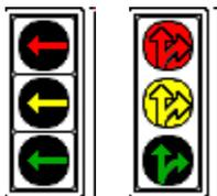
Светофоры со стрелками применяются для регулирования движения транспортных средств, определяя дополнительные ограничения на направления движения
