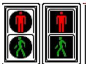
Если сигнал светофора выполнен в виде силуэта пешехода, то его действие распространяется только на пешеходов. При этом зеленый сигнал разрешает, а красный запрещает движение пешеходов.
